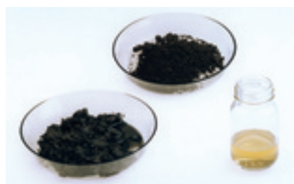
Tout en protégeant l'environnement, on récupère les huiles de coupe onéreuses avec le CO 2 sous haute pression
