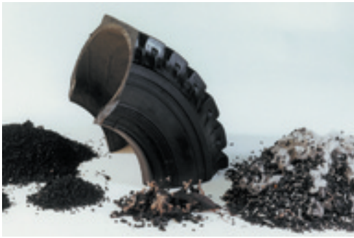
Pneus usés transformés en granulats de caoutchouc. Il est plus facile de broyer les matériaux élastiques à basses températures.
